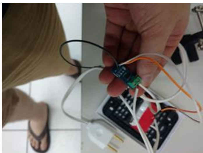
FIGURA 8 - Primeira instalação com o sensor ACS712.
