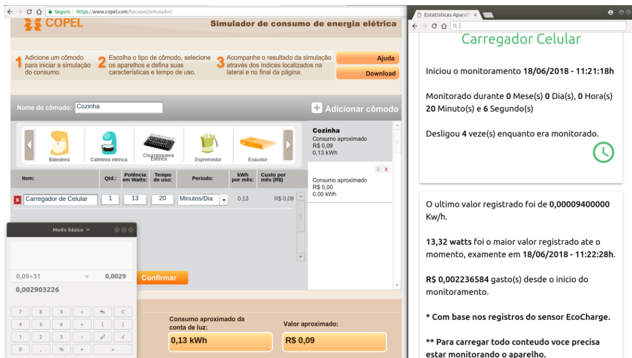
FIGURA 17 - Comparação das estatísticas de um aparelho monitorado no aplicativo EcoCharge em relação ao simulador da Copel(Companhia Paranaense de Energia).
