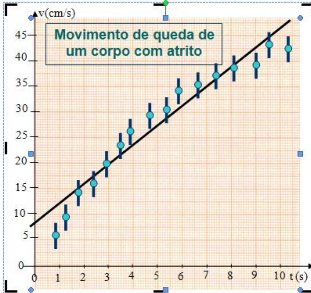
Figura 4.7. Conjunto de dados no qual o uso de uma reta média não é adequado para descrever o comportamento dos dados.
